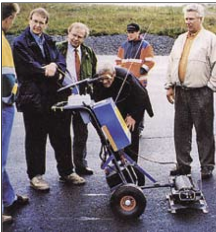
Рис. 1. Радиационный самопередвигающийся измеритель плотности асфальтобетона DOR-1000
