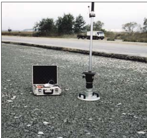
Рис. 5. Малогабаритная установка динамического нагружения (УДН) для измерения модуля деформации на поверхности щебеночного основания и земляного полотна
