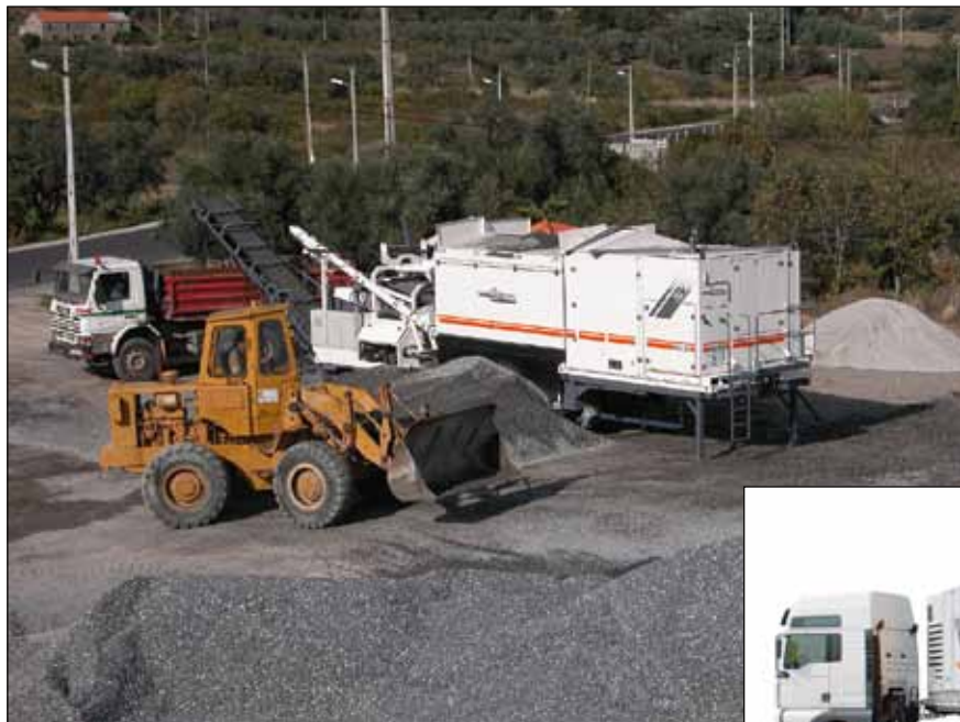
Рис. 6. Мобильная смесительная установка КМА-200 фирмы Wirtgen
