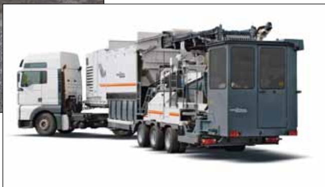
Рис. 6. Мобильная смесительная установка КМА-200 фирмы Wirtgen
