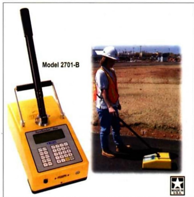
Рис. 7. Электромагнитный прибор «Pave Tracker Plus 2701-B» фирмы Troxler (США) для контроля качества устройства и уплотнения асфальтобетонного покрытия.
