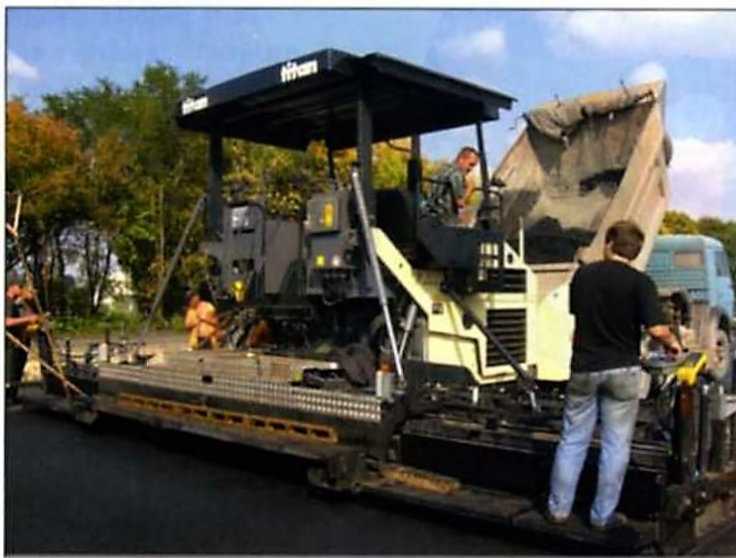
Компания IR-ABG предлагает для укладчика Titan 8820 широкий ассортимент жестких и гидравлических раздвигаемых плит, подходящих для самых разных условий работы.
