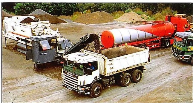
Рис. 12. Смесительная установка КМА 200 фирмы Wirtgen для приготовления холодной смеси из фрезерной асфальтобетонной крошки и вяжущих добавок при устройстве дорожного основания.
