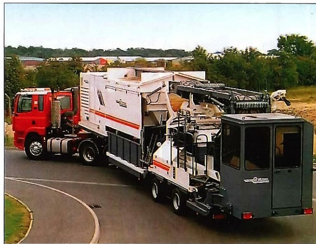
Рис. 13. Оперативная мобильность установки КМА 200 обеспечивается всего одним автотягачом.
