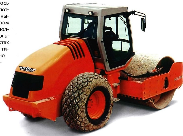
Рис. 2. Одновальцовый виброкаток 3414 фирмы Hamt для уплотнения грунтов земляного полотна и щебеночных оснований.
