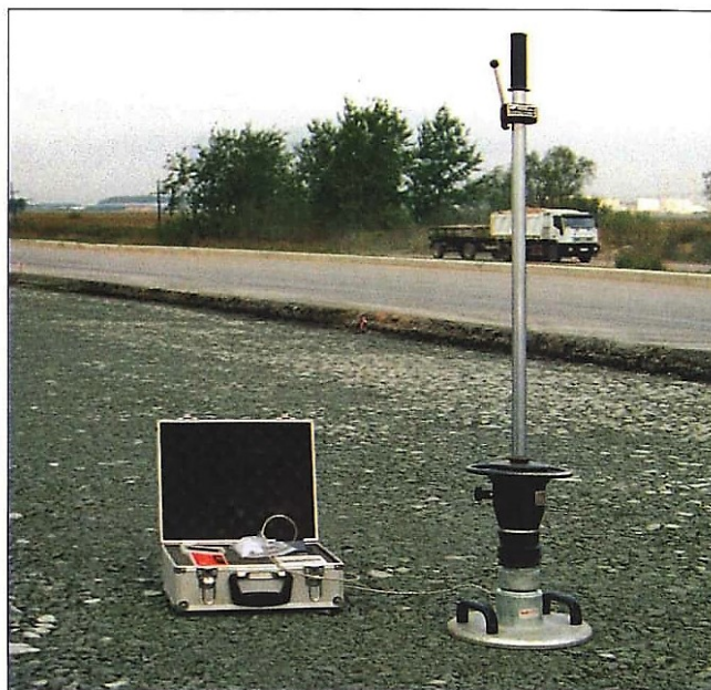
Рис. 7. Малогабаритная установка динамического нагружения (УДН) для измерения модуля деформации на поверхности щебеночного основания.
