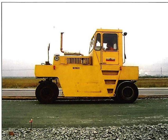
Пневмоколесные катки достаточно полезны на заключительной стадии устройства основания.
