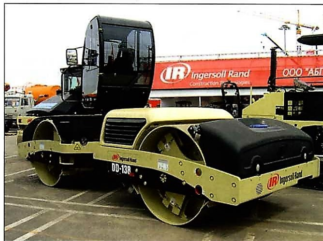
Новый виброркаток DD138 HFA (13,8 т) фирмы Ingersoll-Rand (IR) позволяет более широко регулировать усилия уплотнения.
