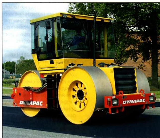
Статический трехвалцовый гаток CS141/142 фирмы Дупарас, полезный для завершающей фазы технологии укатывания асфальтобетона.
