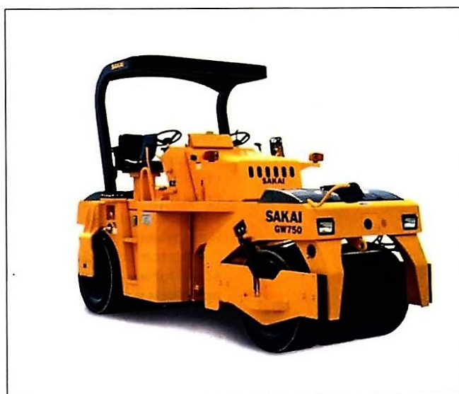
Рис.1. Вибрационный пневмоколесный каток GW750 японской фирмы Sakai (вес 9,3 т, ширина укатки 1,96 м, частота колебаний 40 Гц, амплитуды 0,10; 0,31; 0,53 и 0,74 мм, ожидаемый эффект уплотнения может быть выше эффекта от статического пневмокатка весом 25 т)
