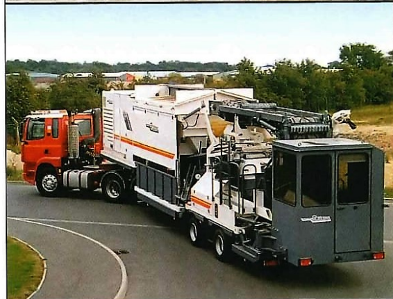
Рис. 3. Мобильная смесительная установка КМА200 фирмы Wirtgen для выполнения работ по технологии холодного ресайклинга
