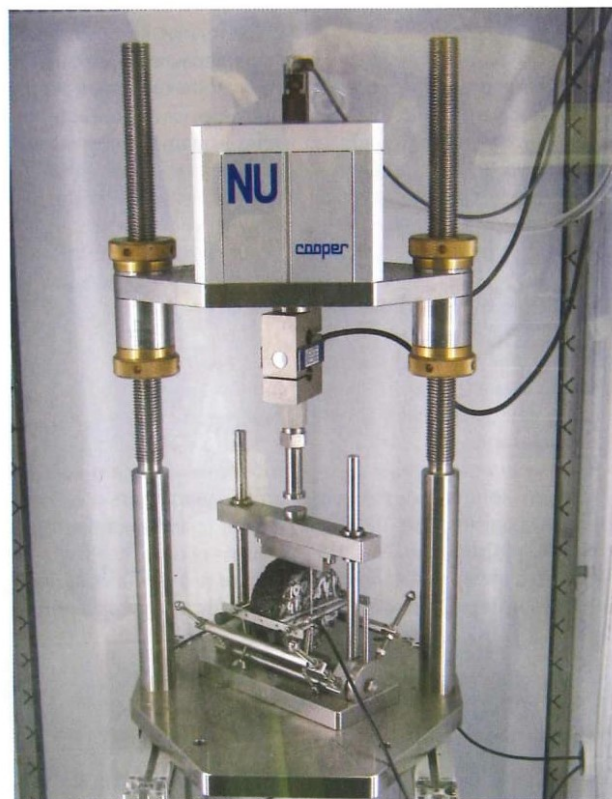
Рис. 4. Оборудование фирмы COOPER Technology по определению модуля жесткости в соответствии с европейским стандартом EN 12697-26 Метод С.
