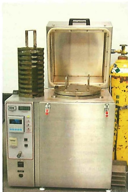
Рис. 2. Оборудование для проведения испытания битума на старение — прибор для старения под давлением PAV для имитации старения вяжущего в течение эксплуатационного периода. Материал после старения в печи RTFO помещают в плоских чашках в сосуд под высокое давление и выдерживают при температуре 90-110 °С в течение 20 часов, воздействие соответствует 7-10 лет эксплуатации.
