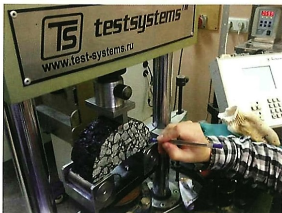
Рис. 10. Схема испытания на трещиностойкость полуцилиндрических образцов с глубиной пропила 10 мм по EN 12697-44:2010 [9]
