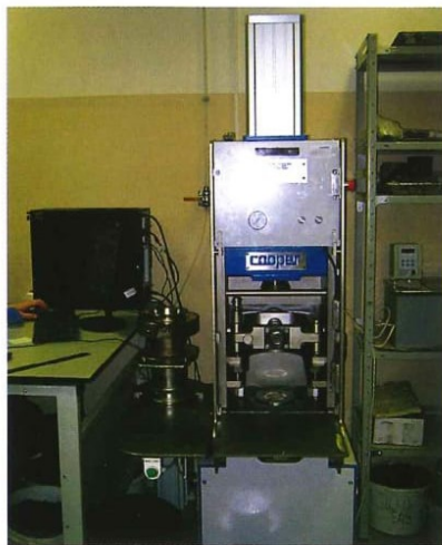
Рис. 5. Гиратор-компактор фирмы COOPER Technology
