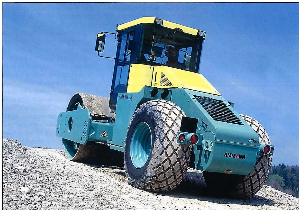
Грунтовый одновальцовый шарнирно-сочлененный каток AC110 (фирмы Ammann) оборудован электронной контрольно-измерительной системой ACE.
