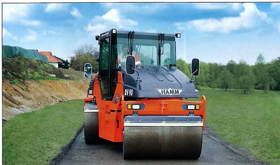
Каток DV90 (фирма HAMM) оснащен системой рулевого управления джойстиком HI-DRIVE.
