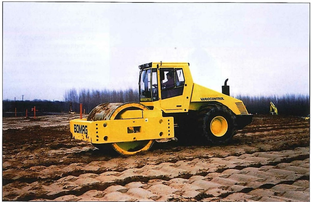
Рис. 1. Виброкаток BW225 B-3 BVC фирмы Voitag для эффективного уплотнения связных и других разновидностей грунтов.
