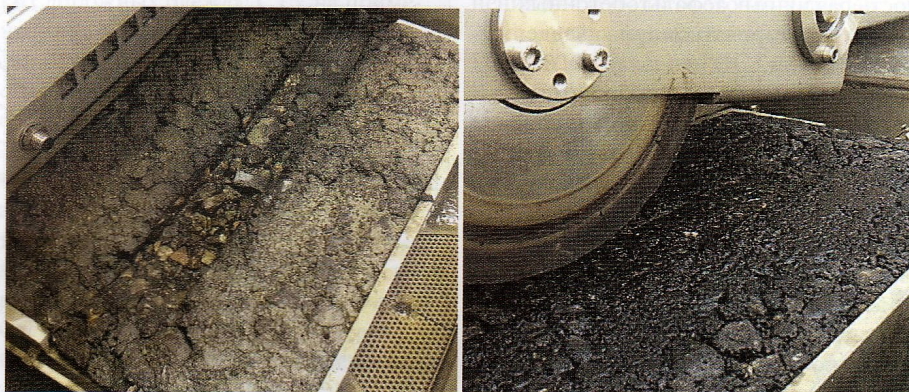
Рисунок 4. Образцы-плиты после испытания на колееустойчивость в воде при 60° с прокатыванием металлическим колесом
