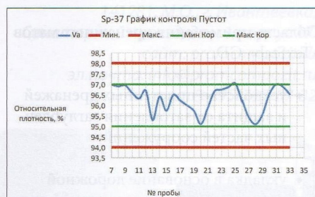
Рисунок 6. График контроля пустот через относительную плотность
