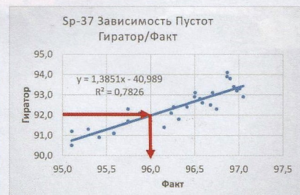
Рисунок 5. Зависимость геометрической плотности, определяемой в процессе уплотнения на гираторе и фактической плотности, определяемой гидростатическим методом
