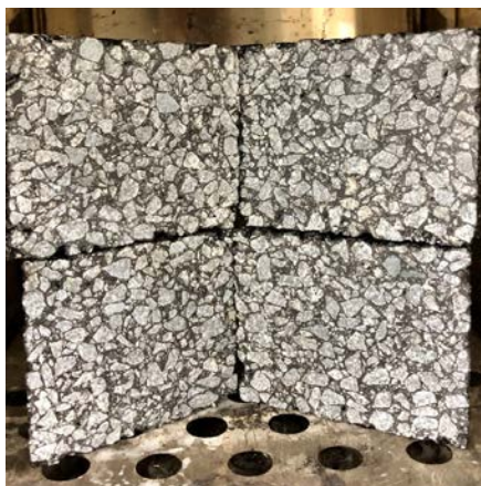
Рисунок 7. Внутренняя, плотная структура высококонтактного асфальтобетона ВАД-15 с содержанием вяжущего 4,2%
