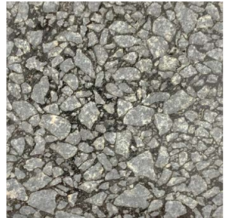
Рисунок 4. Пример упаковки зерен щебня асфальтобетона SMA-16, рассчитанного с использованием линии максимальной плотности
