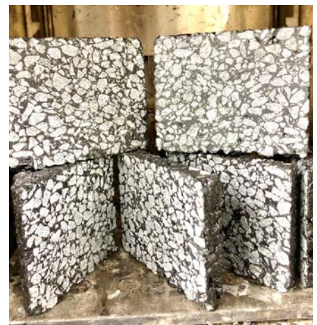
Рисунок 6. Внутренняя структура ЩМА-15У
