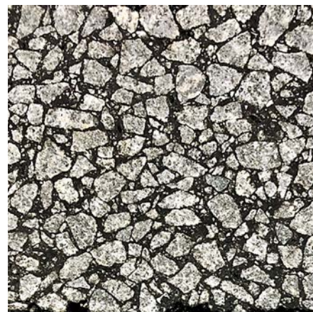
Рисунок 7. Внутренняя, плотная структура высококонтактного асфальтобетона ВАД-15 с содержанием вяжущего 4,2%
