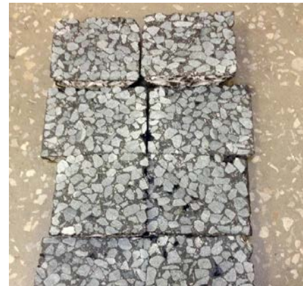
Рисунок 2. ММС-20 укладка тонким (3 см) слоем в Вологодской обл.; структура разрезанных гираторных образцов.
